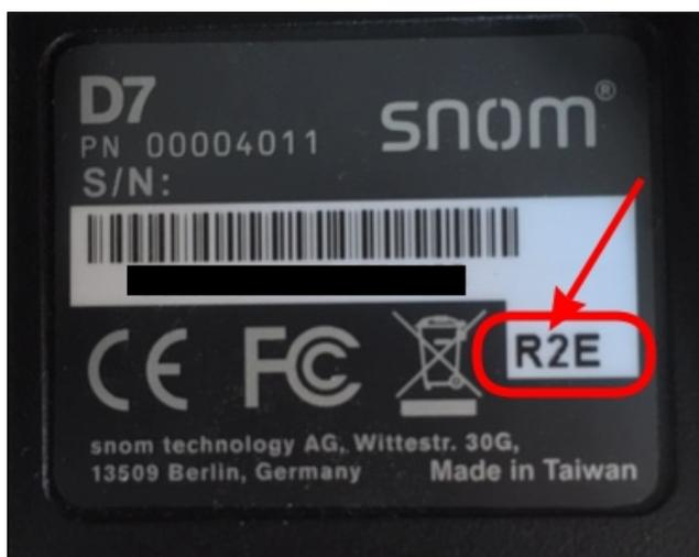
Si la version de matériel porte la mention « R2E », c'est donc une ancienne version de matériel, qui ne fonctionne pas bien avec certains téléphones de SNOM s'il s'agit du premier module d'extension dans la chaîne. Si tel est le cas, un RMA doit être effectué et le fabricant remplace le module d'extension par un modèle plus récent avec la version de matériel « R4A ».
