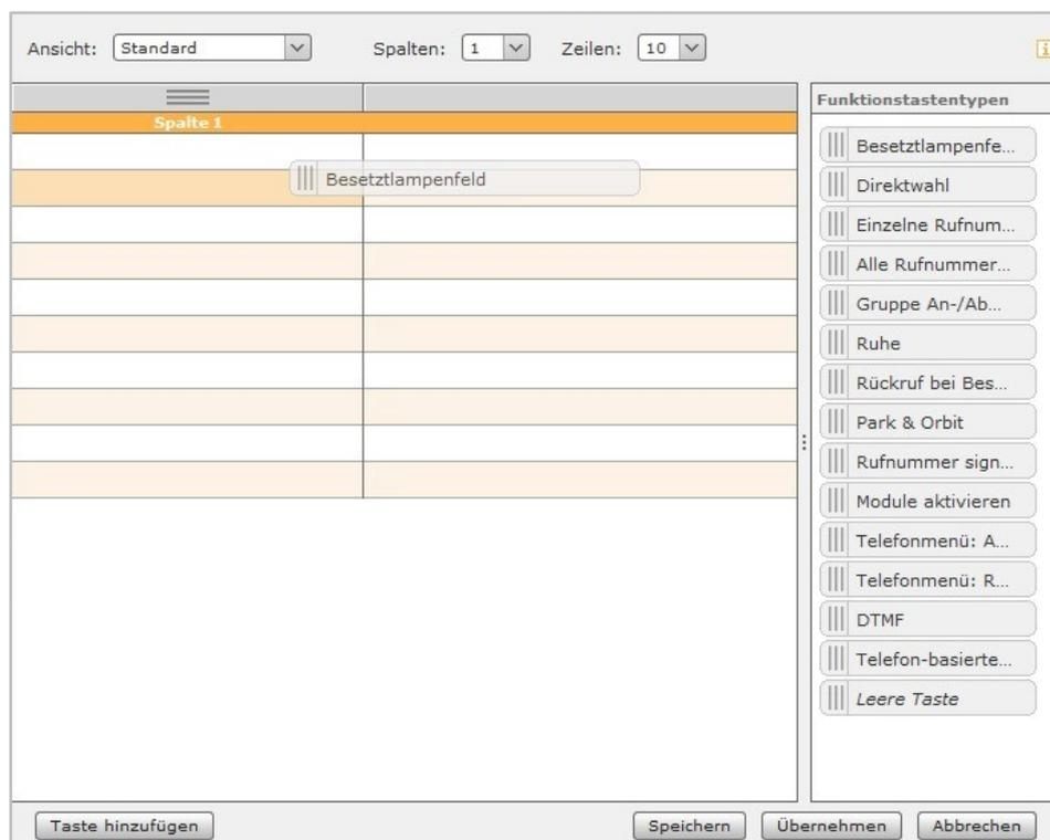
Abbildung 13- Erstellen einer BLF via Drag&Drop
