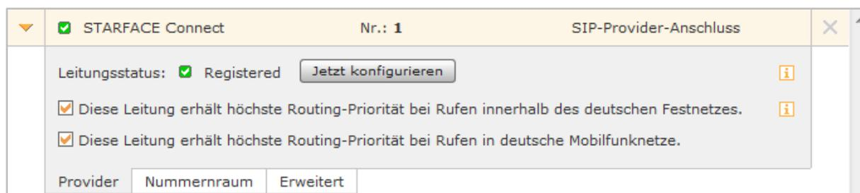
Abbildung 36 - Beispiel für eine registrierte STARFACE Connect Leitung
