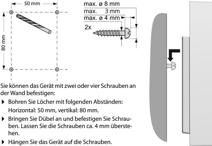
Sie können das Gerät mit zwei oder vier Schrauben an der Wand befestigen:
