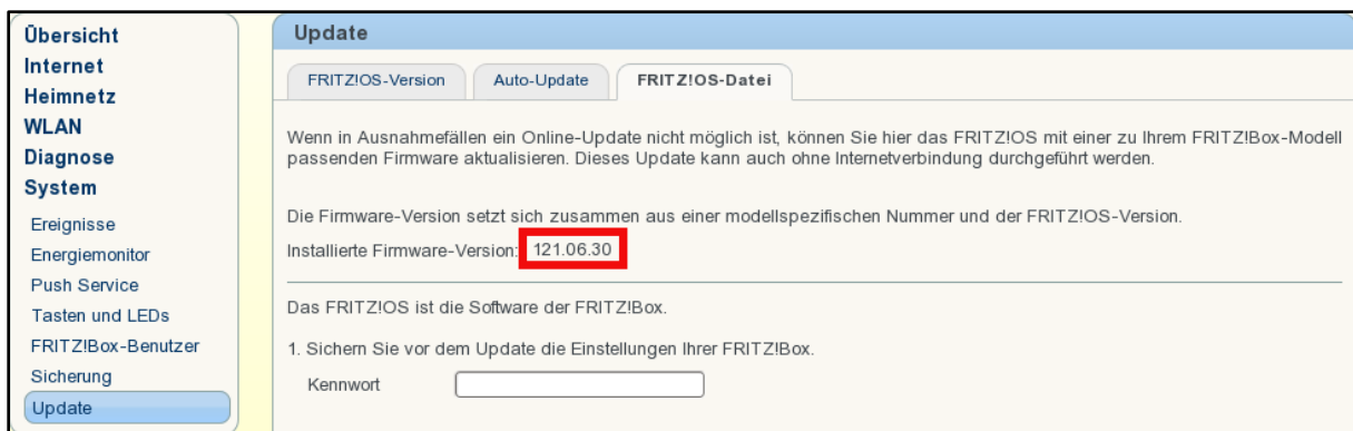
Abbildung 1 - Kontrolle der Firmware Version der Fritzbox 3390
