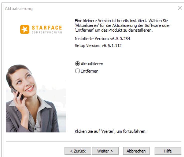
Abbildung 2 - Setup wenn eine bereits installierte Version erkannt wird
